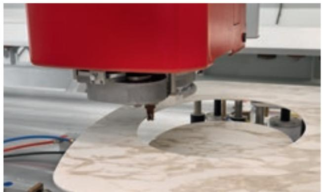
Der Arbeitstisch kann mit maximal 40 Teleskop-Saugtellern ausgestattet werden, die unterschiedliche Abmessungen und Formen haben können. Die Teleskop-Saugteller werden automatisch von der in die Maschine integrierten Software verwaltet und mit den spezifischen, von Interamac entwickelten Funktionen programmiert.
